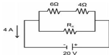
No circuito, por onde passa uma corrente elétrica de 4.A, três resistores estão conectados a uma fonte ideal de força eletromotriz de 20 V. Os valores da resistência total deste circuito e da resistência  $R_X$  são, respectivamente:
